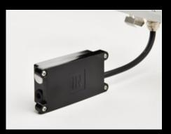
Boîtier externe de connexion électrique en technopolymère approprié pour des câbles de Ø6 - 9 mm en caoutchouc. Celui-ci est raccordé à l'appareil par 25 centimètres de câble.
